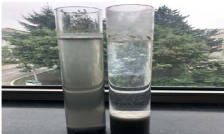
图7 污水除油、絮凝剂、混凝剂评价试验
