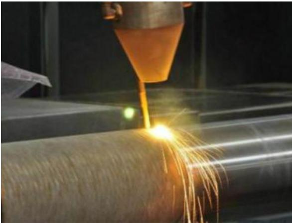
图2 激光热处理技术应用图
