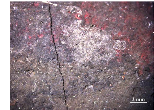
图1-4 加强管座焊缝处的宏观、低倍形貌（内壁）
