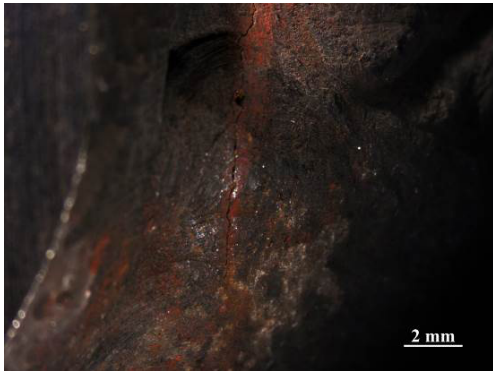
图1-3 加强管座裂纹A的低倍形貌（外壁）
