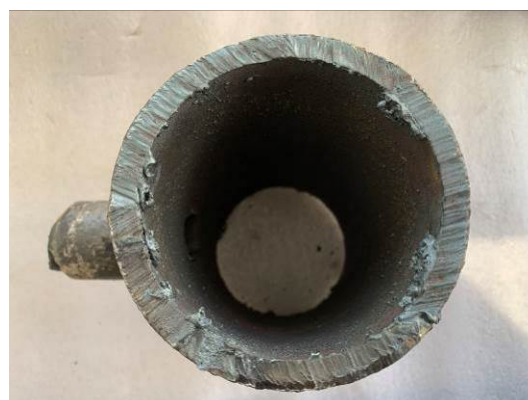
图1-1 蒸汽管线加强管座处的宏观形貌（外壁）
