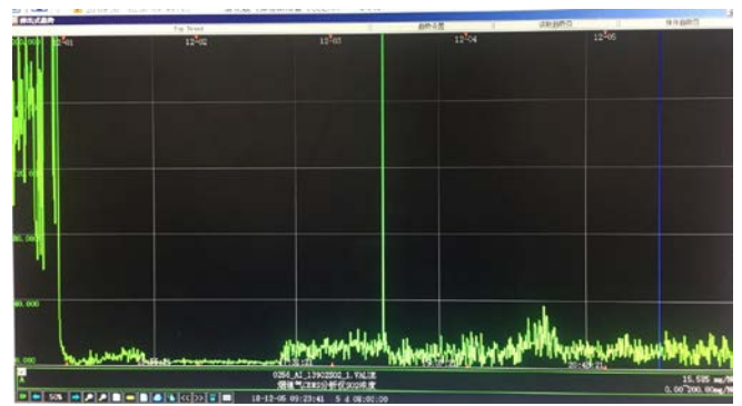
图4 停工吹硫烟气经超重力脱硫净化后二氧化硫排放数据
